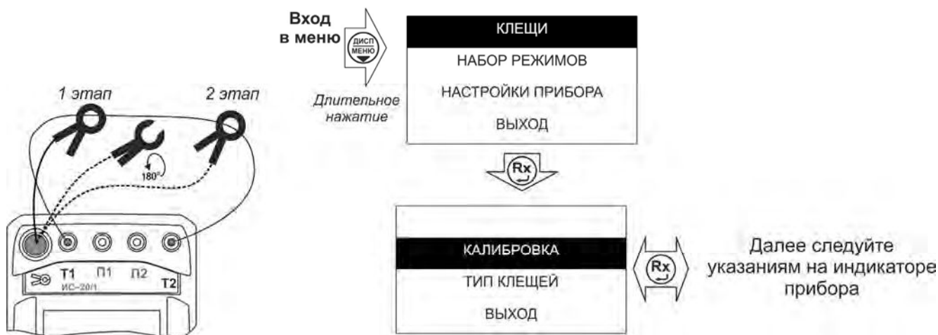
Рисунок 2.14 – Калибровка токоизмерительных клещей
